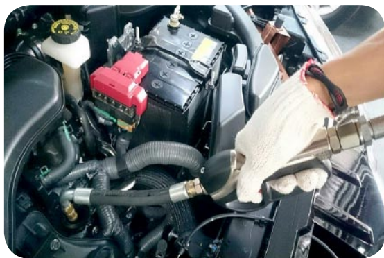
機油油槍設施
